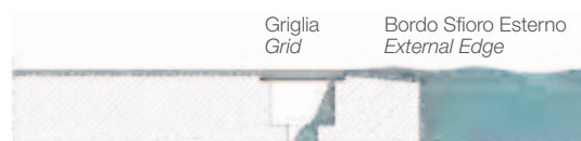
SFIORO ESTERNO 2 EXTERNAL EDGE 2
