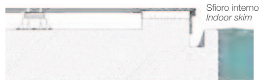
SFIORO INTERNO 3 CON BORDO A COSTA RETTA DECREASED WATER LEVEL 3 COSTA RETTA EDGE
