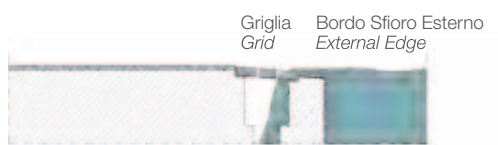
SFIORO ESTERNO 1 EXTERNAL EDGE 1
